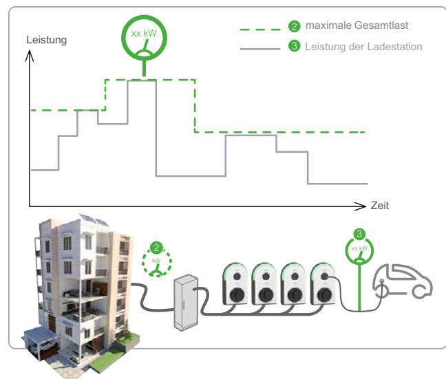
Funktionsweise Last- und Lademanagement-System EcoStruxure™ EV Charging Expert
