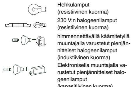
Valonsäädin tunnistaa kytkeytyn sähkölaitteen automatisesti.
