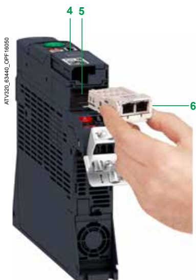
Példa egy kommunikációs modul (6) beszerelésére (alulról nézve) egy könyv kialakítású frekvenciaváltón
