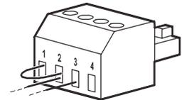
**Nota:** Il pin 1 è la fonte di alimentazione per il circuito EPO e genera alcuni milliampere di alimentazione a 24 V.
