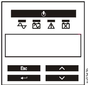
Restablezca la fecha de instalación de la batería de la batería interna del SAI.
