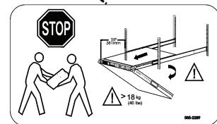
Sicherstellen, dass beide Leisten ordnungsgemäß in der Schiene positioniert sind.
