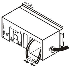
5 Cierre la puerta del compartimento de la batería y asegúrela con los dos tornillos extraídos previamente.
