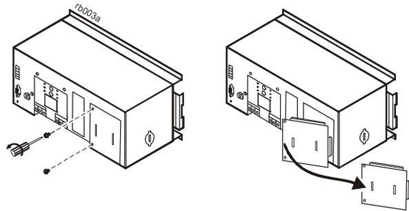
2 Retire el panel extraíble que resulte más conveniente para realizar la conexión de la batería externa. Utilice un destornillador para retirar el panel extraíble.
