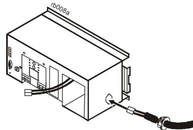
4 Una los dos conectores de la batería presionándolos entre sí con firmeza.
