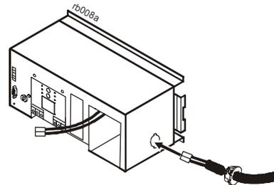
❹ Collegare saldamente i due connettori della batteria. Posizionare i connettori della batteria nel relativo scomparto.
