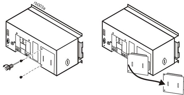
❷ Rimuovere il pannello con foro predisposto in posizione più pratica per il collegamento della batteria esterna. Utilizzare un cacciavite per rimuovere il pannello con foro predisposto.
