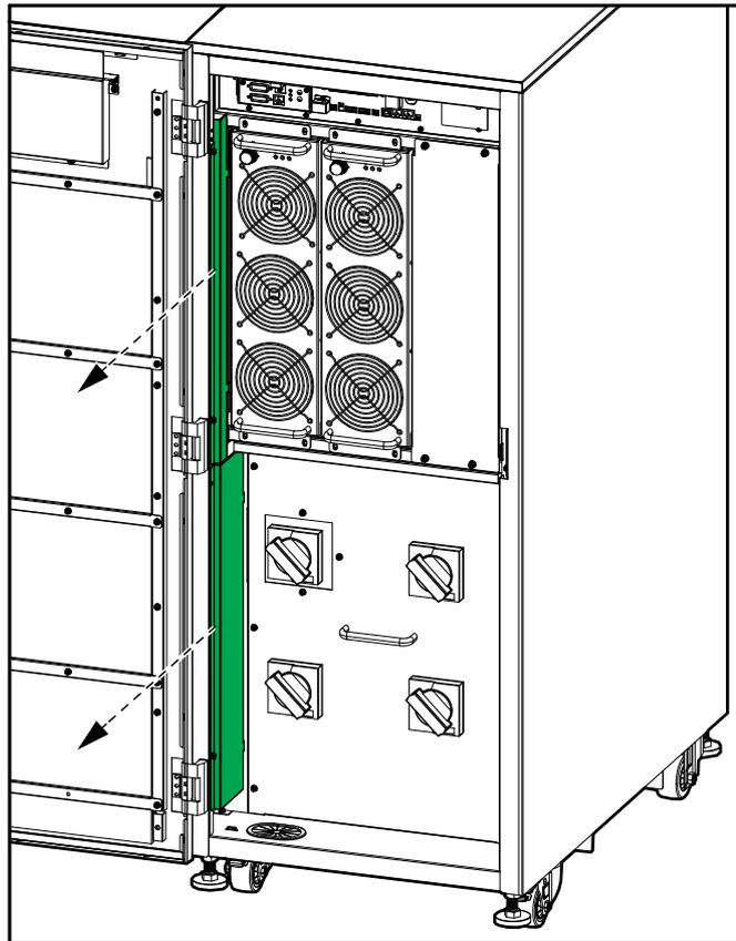
2. Far passare i cavi di segnale nella parte inferiore fino all'interfaccia di comunicazione. Fissare i cavi nei serracavi.
