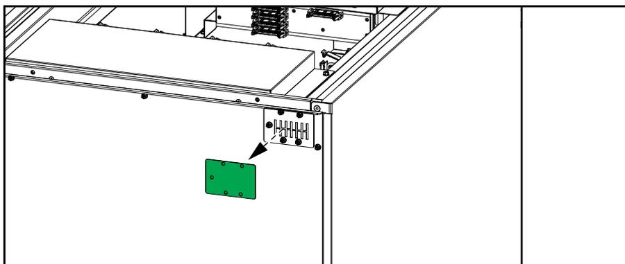
3. Far passare i cavi di segnale attraverso la piastra della spazzola posteriore e attraverso il canale per i cavi fino all'interfaccia di comunicazione sulla parte anteriore dell'UPS.
