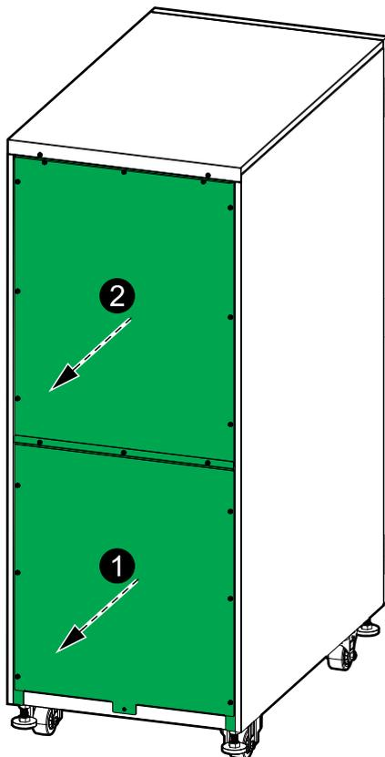
2. Rimuovere la piastra superiore dal lato posteriore dell'UPS. Smaltire la piastra e conservare le viti per reinstallare la piastra superiore IP30.
