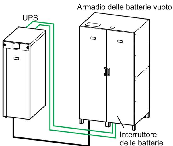
**Panoramica dei cavi per installazioni con due armadi delle batterie vuoti (GVEBC11) da 1100 mm**
