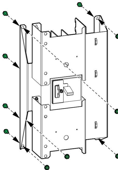
1. Misurare e segnare i fori per il montaggio del kit interruttore delle batterie nella scatola metallica.
