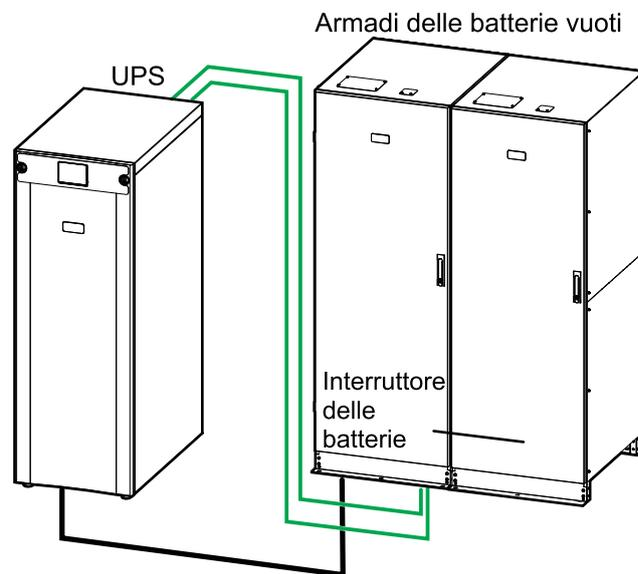
**Panoramica dei cavi per installazioni con un armadio delle batterie vuoto (GVEBC11) da 1100 mm**
