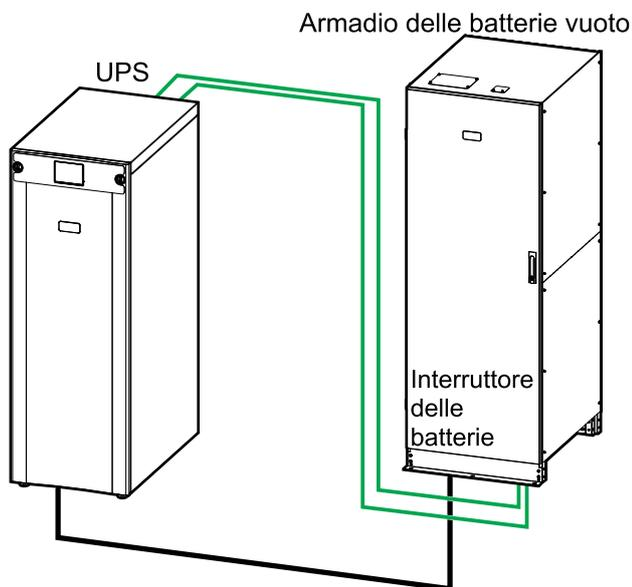
**Panoramica dei cavi per installazioni con due armadi delle batterie vuoti (GVEBC7) da 700 mm**
