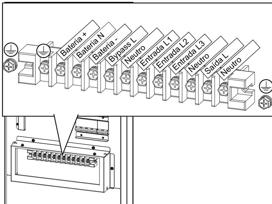
6. Conecte os cabos de entrada, os cabos de saída e os cabos de bypass (se aplicável).
