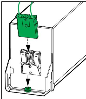
4. Remova os tubos de isolamento dos terminais elétricos e conecte os terminais elétricos às baterias.
