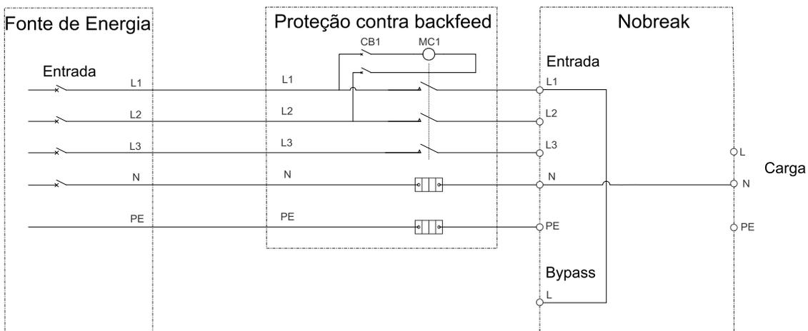
**Nobreak de alimentação dupla e dispositivo de isolamento externo**
