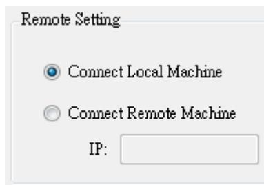
È possibile collegarsi in remoto all'installazione di UPSCAPO da un altro computer. È sufficiente selezionare "Connect Remote Machine" [Connetti macchina in remoto] e inserire l'indirizzo IP. L'opzione "Connect Remote Machine" [Connetti macchina in remoto] non consente di inviare comandi come Scheduling [Programmazione] o UPS turn off [Spegnimento UPS]. Tuttavia, permette di spegnere il computer.
