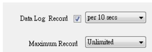
Selezionare la voce per attivare la registrazione nel registro dati, per impostare l'intervallo di tempo di registrazione e per impostare il limite di memorizzazione dei dati.
