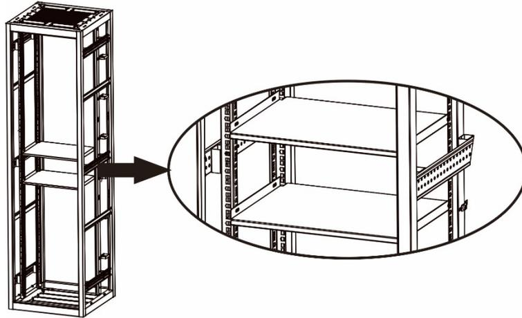
Siga las instrucciones que se indican a continuación para fijar y colocar la batería externa en el espacio del armario de 48 cm (19 pulgadas).
