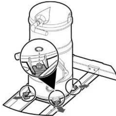
图3-46 拆除压缩机运输固定钣金
