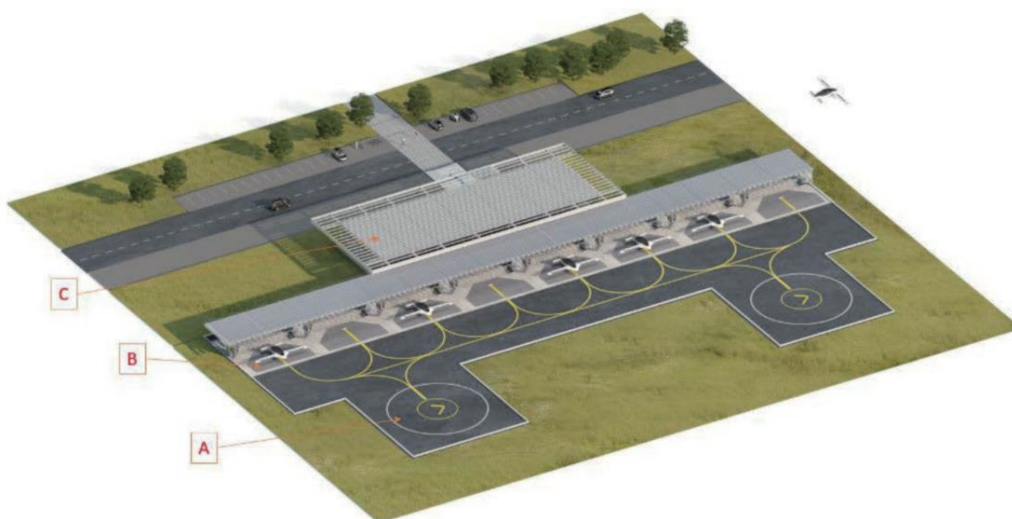
(图 4) 低空起降场站布局，包括(A)起飞区、(B)充电机库和(C)航管中控终端
