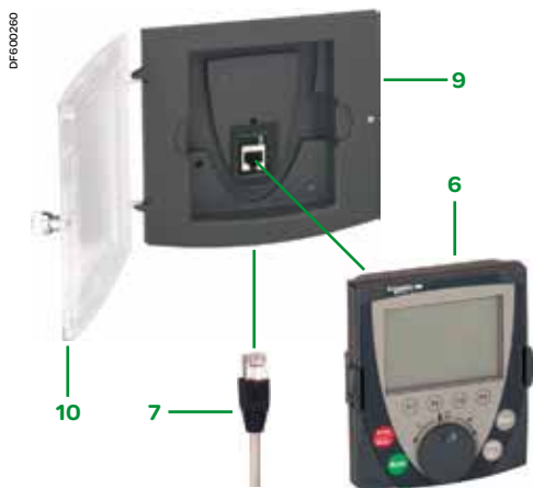
图形显示终端在电控箱门上的远程位置：IP54时为6+7+9，IP65时为6+7+9+10
