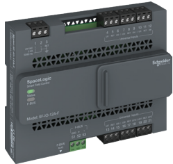
SF-IO-12A-F Smart Field 12路通用输入模块
