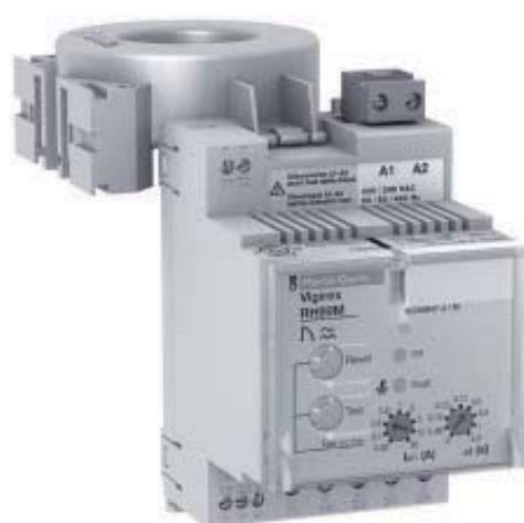
Рис. 11: через посредство тора ток замыкания передает энергию сигнала электромагниту, якорь которого удерживается в притянутом состоянии с помощью постоянного магнита. Когда порог срабатывания достигнут, электромагнит нейтрализует силу притяжения постоянного магнита, якорь под действием пружины отходит от сердечника, приводит в движение контакты – выключатель отключается.
