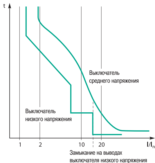
Рис. 18. Согласование с характеристикой выключателя низкого напряжения путем смещения настроек. Защита от перегрузки по низкому напряжению. Ухудшение эффективности защиты от внутренних повреждений.
