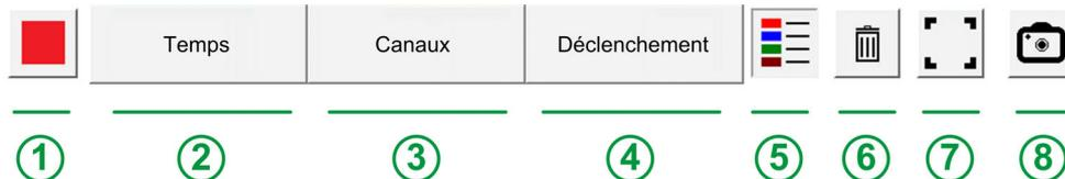
1. **Contrôle** : Permet de démarrer ou arrêter le mode d'acquisition.
