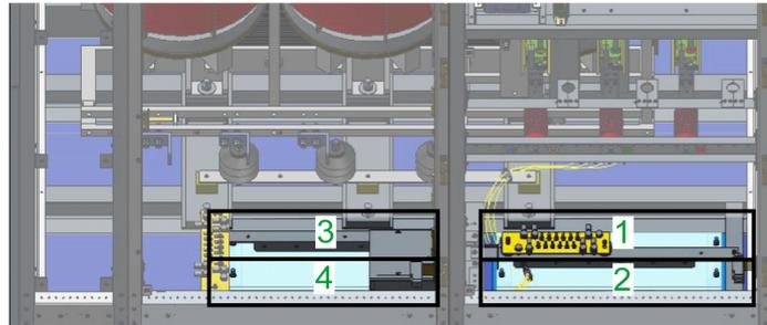
4 demontierbare Aluminiumplatten
