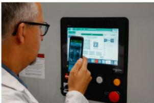
El ATV6000 ofrece una interfaz de código QR inteligente y práctica para proporcionar al operador información relevante del variador. Con un simple escaneo del código QR con un dispositivo móvil (como una tableta o un smartphone) en la placa de identificación o la pantalla HMI, podrá acceder fácilmente a la documentación técnica o al soporte técnico en línea para gestionar los errores de forma sencilla.
