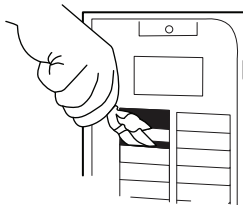
Figure / Figura / Figure 2: Removing Twist-outs / Cómo extraer las placas removibles / Retrait des plaquettes à tordre
