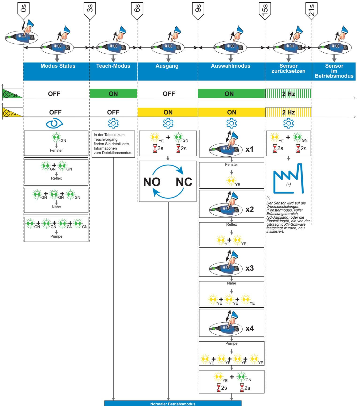
(\*) : Der Sensor wird auf die Werkseinstellungen (Fenstermodus, voller Erfassungsbereich, NO-Ausgang) oder die Einstellungen, die von der Ultrasonic XX-Software festgelegt wurden, neu initialisiert.
