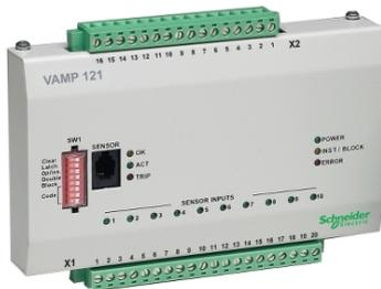
Der ATV6000 kann mit einem Lichtbogen-Erkennungssystem versehen werden (VAMP-Serie). Das System erkennt einen Lichtbogen in einer Installation und löst den Leistungsschalter aus, um einen größeren Stromverlust zu vermeiden. Die Lichtbogenerkennung ist im Transformatorschaltschrank und im PoC-Schaltschrank verfügbar.
