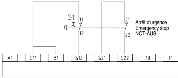
Raccordement de plusieurs boutons arrêt d'urgence
