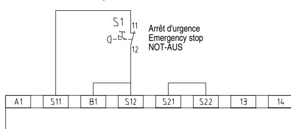
Raccordement du bouton à deux voies, sans détection des courts-circuits
