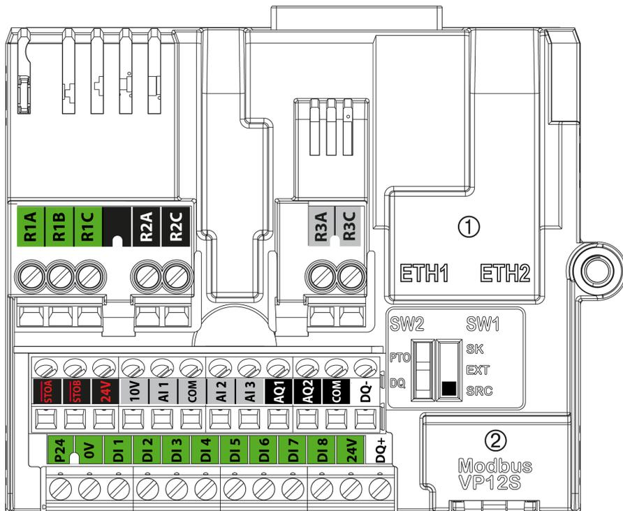
① 以太网 Modbus TCP，② 串行 Modbus
