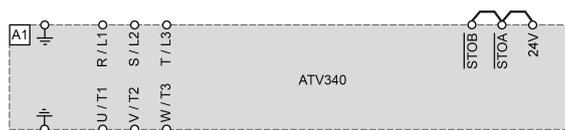
Cuando no se usen para seguridad funcional, las entradas STO deben conectarse a 24 V.
