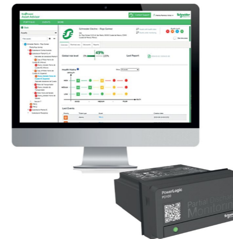
Überwachung der Teilentladung
