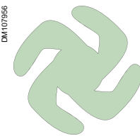
DM107966 Spezifische Kontaktstücke in Vakuumschaltröhre
