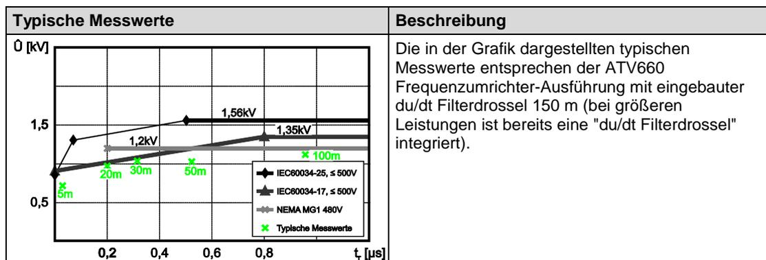
Motoren entsprechend IEC 60034-25 wie auch Motoren entsprechend NEMA MG1 sind für den Betrieb an Frequenzumrichtern dimensioniert und eignen sich daher bestens für Antriebe mit ATV660 Frequenzumrichtern.
