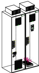
Diese Kundenanpassung dient zum Beheizen des Schaltschranks, um Frost und Kondenswasserbildung bei einer Umgebungstemperatur von bis zu -10°C zu vermeiden. Die Schrankheizung wird extern versorgt, wodurch der Schrank auch bei ausgeschalteter Netzspannung beheizt werden kann.
