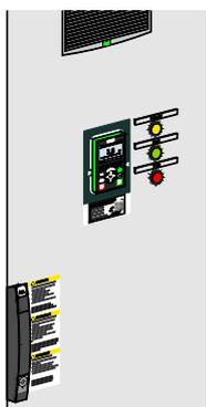
Für eine rasche, optische Diagnose des aktuellen Betriebszustandes aus größerer Entfernung kann der Schaltschrank mit Meldeleuchten ausgestattet werden.
