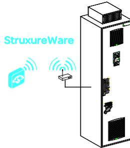
Das mitgelieferte Gateway protokolliert die Daten des Drive Systems in regelmäßigen Intervallen. Die gesammelten Daten werden mittels eines integrierten GPRS-Modems über das Mobilfunknetz an das Schneider Electric StruxureWare Energy Operation Netzwerk übermittelt.
