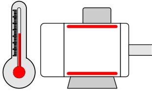
Verfügt der Motor zum Schutz vor thermischer Überlastung über integrierte Kaltleiterfühler, so können diese direkt an ein Kaltleiterauslösegerät im Altivar Process Drive System angeschlossen werden.
