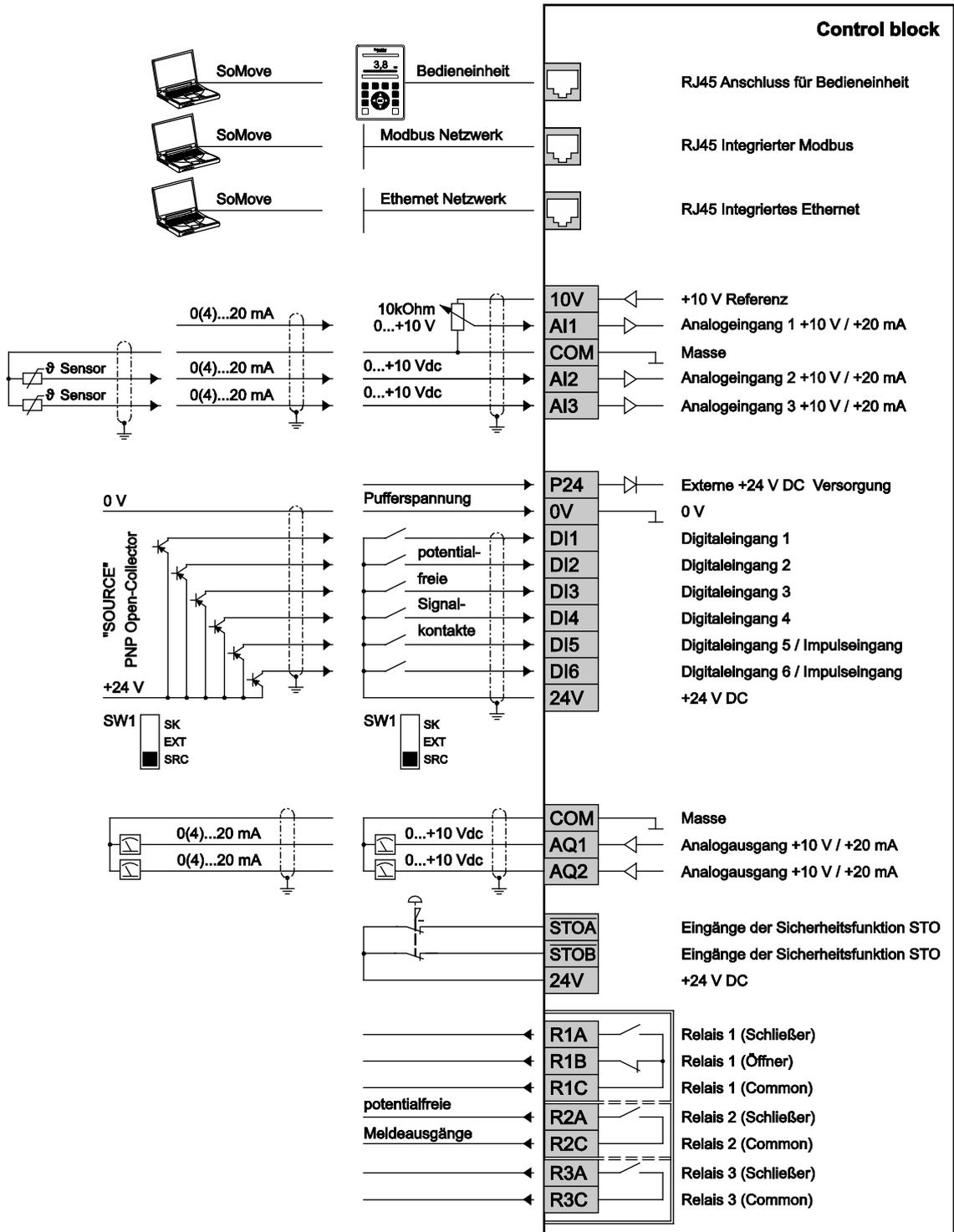
Spezifikation der Steueranschlüsse
