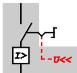
Fällt die Spannung an der Unterspannungsspule ab, so schaltet der Leistungsschalter aus. Diese wird in den Leistungsschalter eingebaut und an die Optionsklemmleiste verdrahtet.
