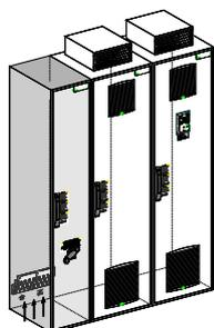
Dieses separate Anschlussfeld ermöglicht es, die Netz- und Motorkabeln von unten in den Schaltschrank einzuführen und anzuschließen.
