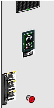
Über einen NOT-HALT-Taster in der Schranktür oder weitere eingebundene, externe Überwachungseinrichtungen kann das Drehmoment am Motor nach SIL 3 Stopkategorie 0 / Performancelevel PL e abgeschaltet werden.
