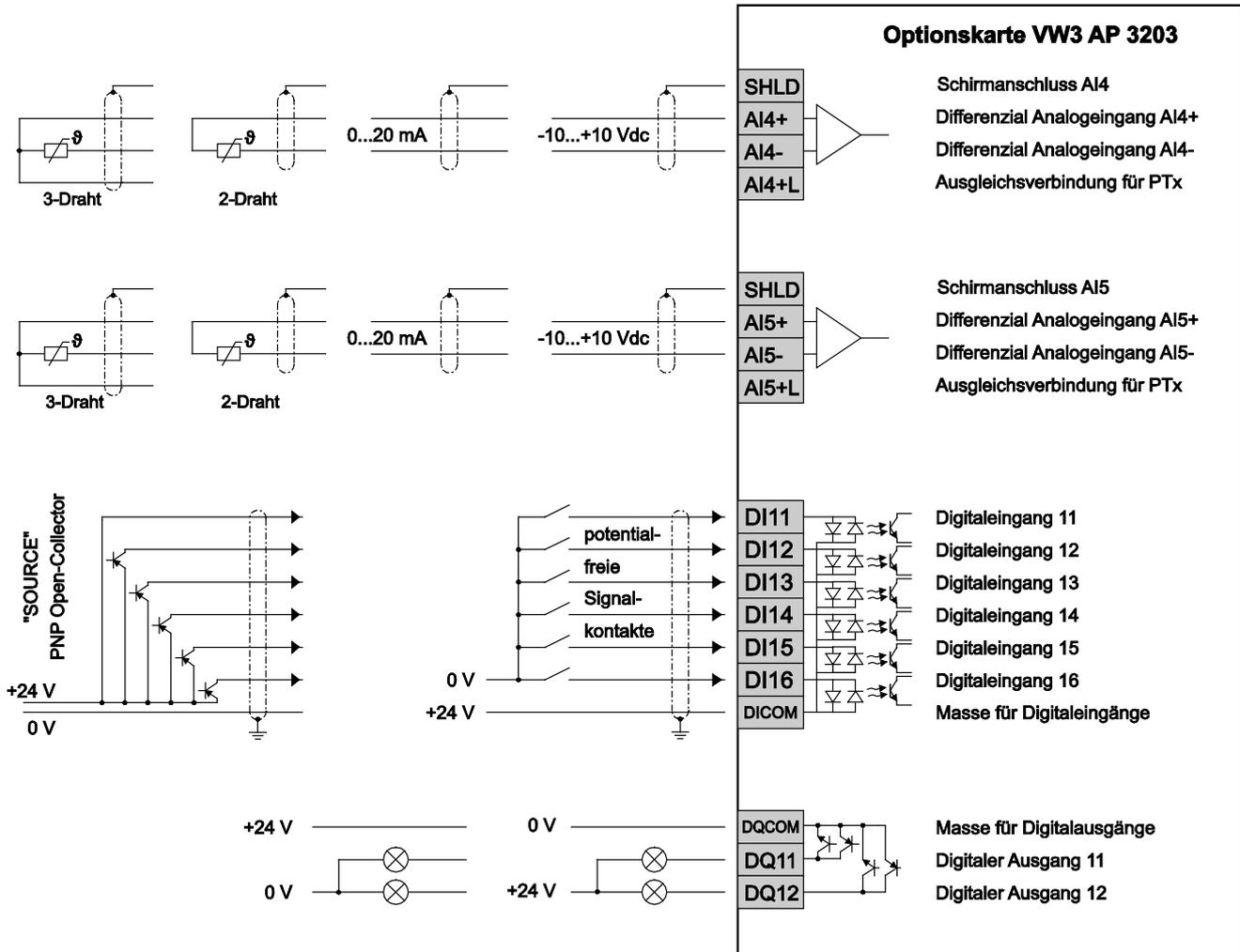
Spezifikation der Steueranschlüsse
