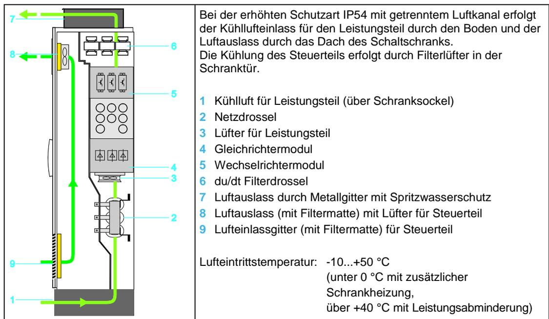
**HINWEIS:** Durch den zusätzlichen Schranksockel erhöht sich der Schaltschrank um 200 mm auf eine Gesamthöhe von 2350 mm.
