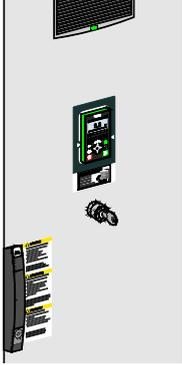
Der Schlüsselschalter "Local / Remote" ermöglicht die Umschaltung zwischen der Bedienung vor Ort (über die grafische Bedieneinheit) oder einer Steuerung aus der Ferne (Klemmleiste oder Bus). Der Schalter ist nur mit einem Schlüssel bedienbar und kann daher nur von autorisiertem Personal umgeschaltet werden.
