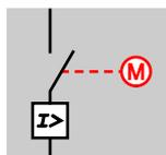
Mittels Motorantrieb kann der Leistungsschalter über Steuerbefehle ferngesteuert werden. Der Motorantrieb wird in den Leistungsschalter eingebaut und an die Optionsklemmleiste verdrahtet.
