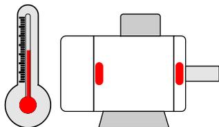
Verfügt der Motor zum Schutz vor thermischer Überlastung über integrierte Temperatursensoren in den Lagern (Pt100, Pt1000, KTY 83/84), so können diese direkt an das Auslösegerät im Altivar Process Drive System angeschlossen werden.
