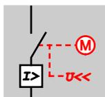
Mit der automatisierten Netztrenn-Einrichtung kann sich das Altivar Process Drive System bei einem Stopbefehl, einer erkannten Störung oder einer Sicherheitsabschaltung über STO selbstständig vom Netz trennen. Die Steuerspannung bleibt jedoch aufrecht. Bei einem Startbefehl wird die Netzspannung automatisch wieder zugeschaltet.
