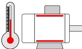
Verfügt der Motor zum Schutz vor thermischer Überlastung über integrierte Temperatursensoren in der Wicklung (Pt100, Pt1000, KTY 83/84), so können diese direkt an das Auslösegerät im Altivar Process Drive System angeschlossen werden.
