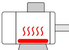
Die Motorstillstandsheizung dient zur Vermeidung von Kondensat und Frostschäden bei Stillstand der Motoren in kalter Umgebung. Die Aktivierung erfolgt mit dem Stillsetzen des Motors.
