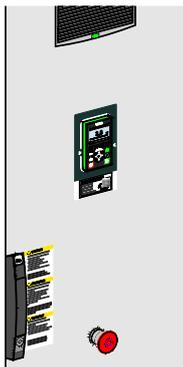
Über einen NOT-HALT-Taster in der Schranktür oder weitere eingebundene, externe Überwachungseinrichtungen kann das Drehmoment am Motor nach SIL 3 Stopkategorie 1 / Performancelevel PL e abgeschaltet werden.
