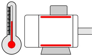
Die Motorüberwachung PTC mit ATEX-Zertifikat dient zur Überwachung der Kaltleiterfühler von Motoren, welche in explosionsgefährdeten Bereichen aufgestellt sind.
