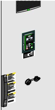
Die Ethernet-Schnittstelle in der Schranktür ermöglicht einen Zugriff auf den Frequenzrichter ohne die Schranktüre öffnen zu müssen. Der Stecker kann mit einer Staubschutzkappe verschlossen werden.
