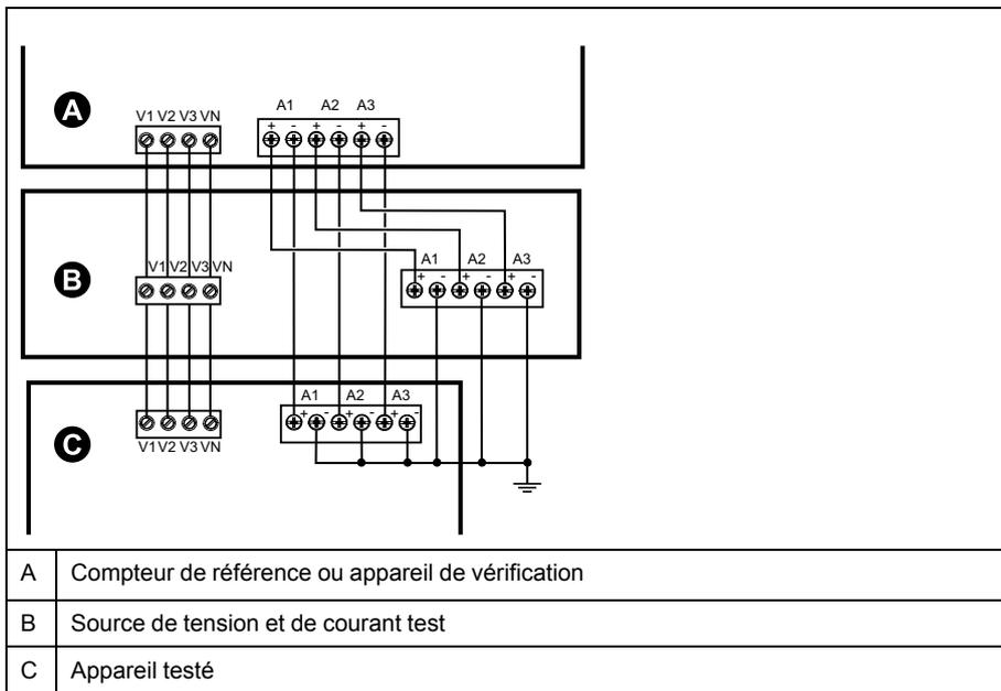
4. Raccordez l'équipement de contrôle utilisé pour le comptage des impulsions de sortie standard à l'aide de l'une des méthodes suivantes :
