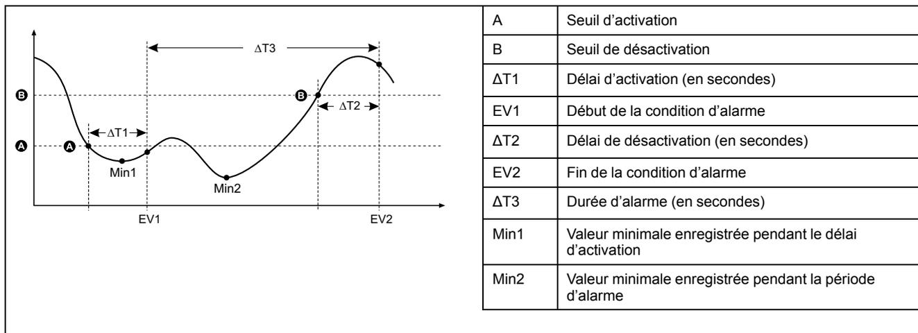
L'appareil enregistre la date et l'heure du début de l'événement d'alarme (EV1) et de sa fin (EV2). L'appareil effectue également les tâches associées à l'événement, par exemple l'actionnement d'une sortie logique. L'appareil enregistre en outre les valeurs minimales (Min1, Min2) avant, pendant et après la période d'alarme.
