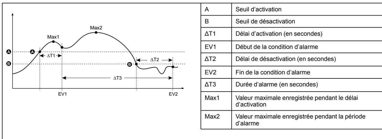
L'appareil enregistre la date et l'heure du début de l'événement d'alarme (EV1) et de sa fin (EV2). L'appareil effectue également les tâches associées à l'événement, par exemple l'actionnement d'une sortie logique. L'appareil enregistre en outre les valeurs maximales (Max1, Max2) avant, pendant et après la période d'alarme.
