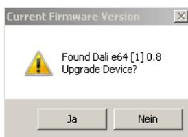
Après la confirmation, les données du micrologiciel sont transférées à la mémoire de l'appareil via FTP. Un indicateur de progression indique l'état du transfert.
