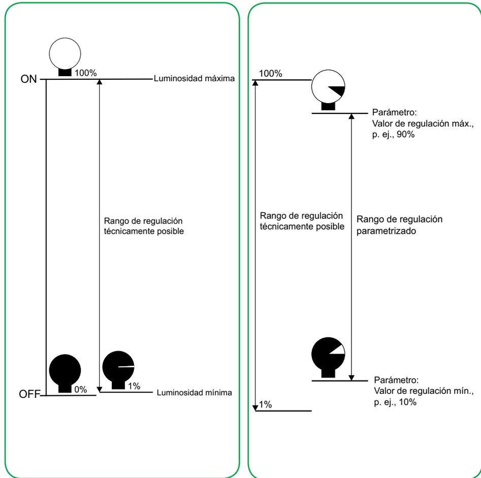
El rango de regulación técnico está definido por el rango entre la luminosidad mínima y máxima de una lámpara y se puede ajustar con la ayuda de un regulador.
