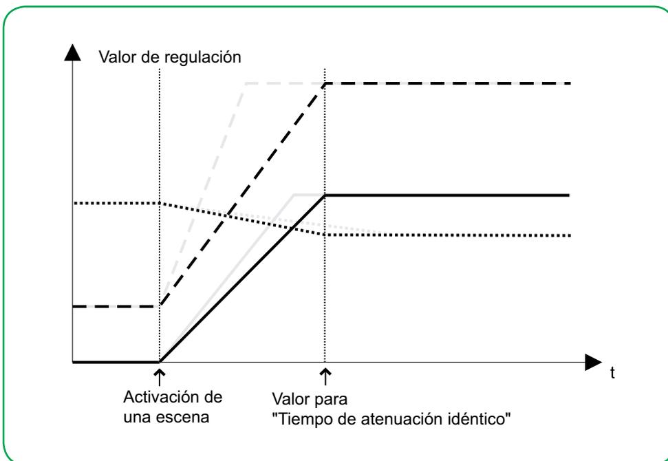
Puede activar la función de forma global para un dispositivo por medio de un parámetro y programar el tiempo de regulación adecuado tras la activación y, a continuación, activar la función *Tiempo de regulación idéntico* en cada canal.
