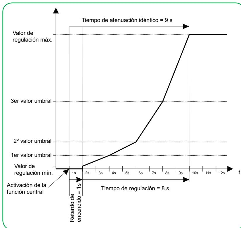
La curva de regulación se comprime de forma que el tiempo total se corresponda con el valor del tiempo de regulación idéntico establecido: Nuevo tiempo de regulación = tiempo de regulación idéntico menos el tiempo de retardo.
