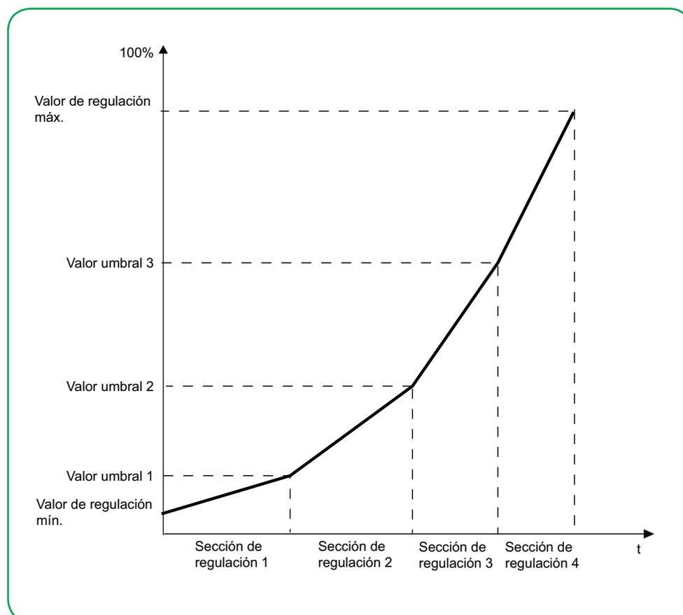
La curva de regulación base se divide en **cuatro secciones de regulación**. Puede ajustar tiempos diferentes a cada sección de regulación. La suma de estos tiempos es el tiempo total de un proceso de regulación.
