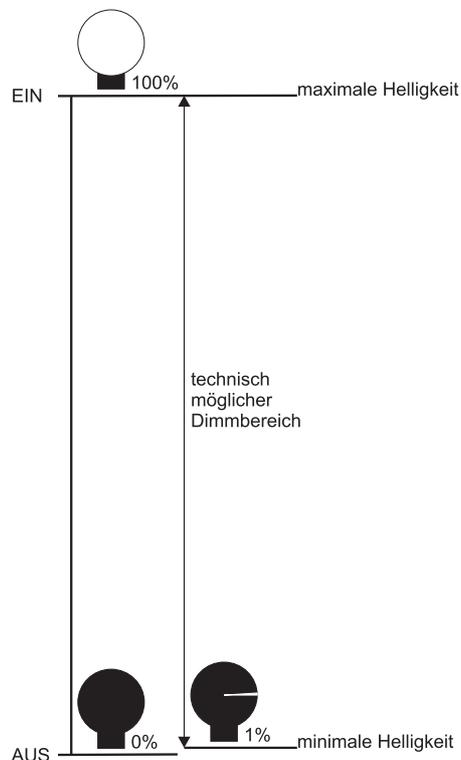
Den technisch möglichen Dimmbereich können Sie mit Hilfe der Softwareapplikation auf einen minimalen und einem maximalen Dimmwert begrenzen. Diese Begrenzung ist für jeden Ausgangskanal individuell möglich.
