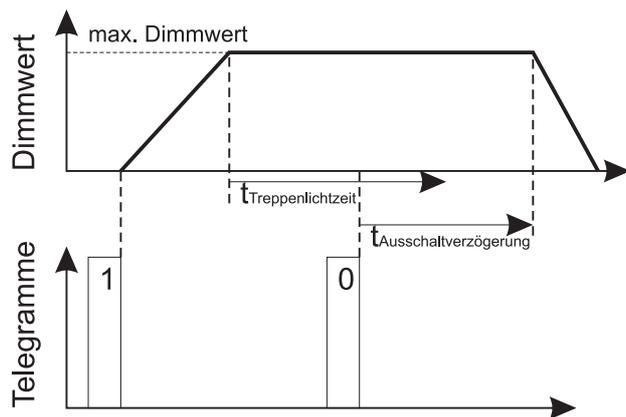
Haben Sie den Parameterwert "ohne manuell-Aus" gewählt, so wird die Treppenlichtzeitfunktion bei Empfang eines Telegramms mit dem Wert "0" nicht unterbrochen, sondern läuft normal weiter bis zum Ablauf der Treppenlichtzeit.
