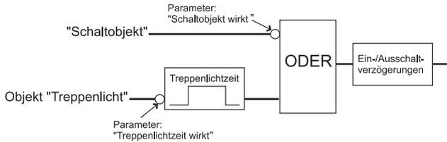
Die Wirkung der beiden Objektwerte auf diese Verknüpfung können Sie über Parameter invertieren (umkehren) oder nicht:
