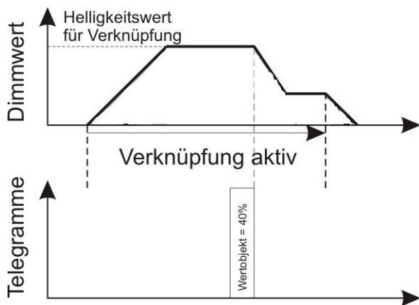
Die Helligkeit des Verknüpfungsergebnisses und die Dimmgeschwindigkeit wird durch das letzte Telegramm definiert.
