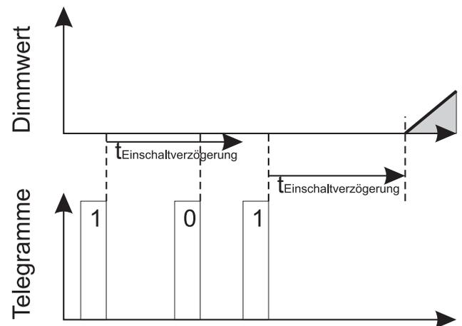
Über einen Parameter können Sie einstellen, ob der Ausgangskanal während der Einschaltverzögerung ausgeschaltet bleibt oder ob er bereits auf den minimalen Dimmwert eingeschaltet wird:
