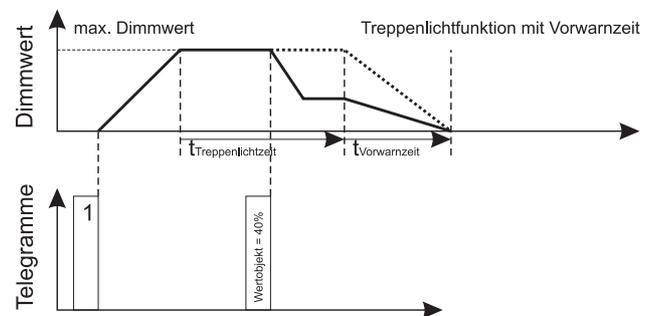
Wenn Sie für den Dimm- ausgang eine Ausschaltverzögerung parametrieren, so beginnt die Vorwarnzeit nach Ablauf der Verzögerungszeit.
