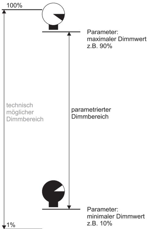
Die Einstellung des parametrieren Dimmbereichs erfolgt über folgende Parameter:
