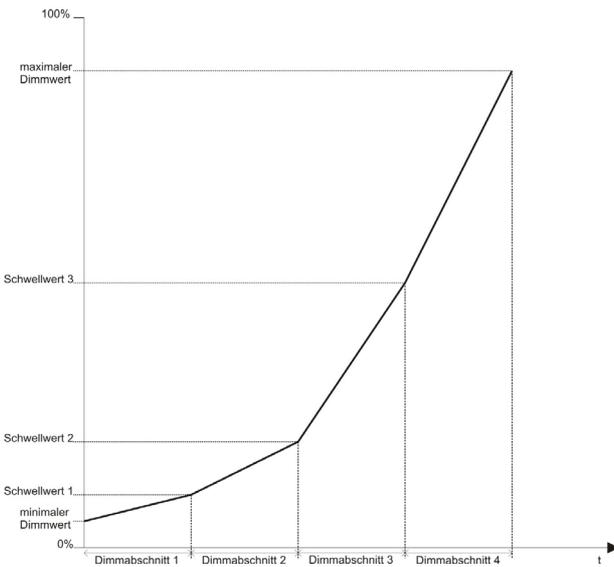
**i** Hinweis: Die Dimmkurve (tatsächlich am Ausgang anliegender Spannungsverlauf über der Zeit) wird noch von den Dimmzeitverkürzungen der Dimmzeitverkürzungssets und vom Dimmzeitverkürzungsobjekt beeinflusst; siehe Abschnitt Dimmgeschwindigkeit.
