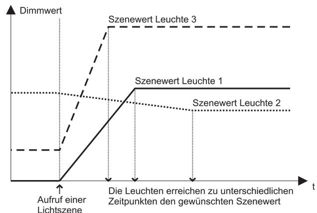
Mit der Funktion „Gleiche Dimmzeit“ können die unterschiedlichen Dimmzeiten der Kanäle so synchronisiert werden, dass alle Kanäle zur gleichen Zeit ihren Sollwert erreichen. Mit dem Parameter „Zeitfaktor über den Bus veränderbar“ (über Kommunikationsobjekt „Faktor gleiche Dimmzeit“) können die Dimmzeiten auch für mehrere Dimmaktoren synchronisiert werden.
