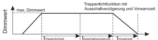
Unabhängig davon, welchen Dimmwert der Ausgang nach Ablauf der Treppenlichtzeitfunktion hat, entspricht die Zeitdauer für den Abdimmvorgang bei einer aktiven Ausschaltvorwarnung immer der Vorwarnzeit.
