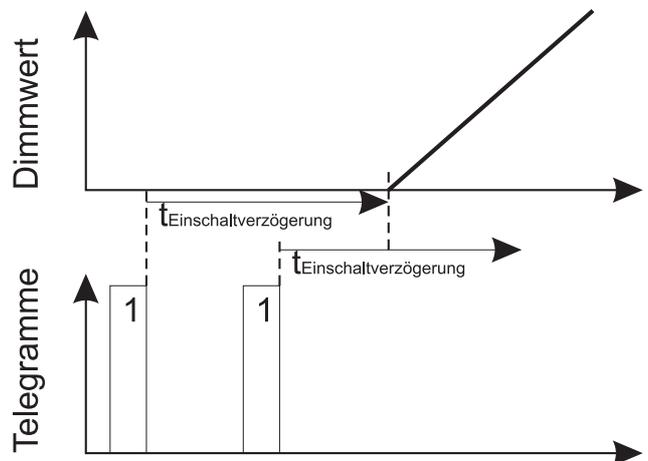
Empfängt der Kanal während einer aktiven Einschaltverzögerung ein Telegramm zum Ausschalten, so wird die Einschaltverzögerung abgebrochen.
