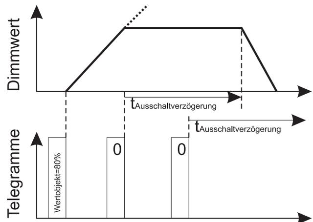
Empfängt der Ausgang während einer aktiven Ausschaltverzögerung ein neues Telegramm, das einen eingeschalteten Zustand zur Folge hat, so wird der Ausschaltvorgang gestoppt und der neue Sollwert wird eingestellt.
