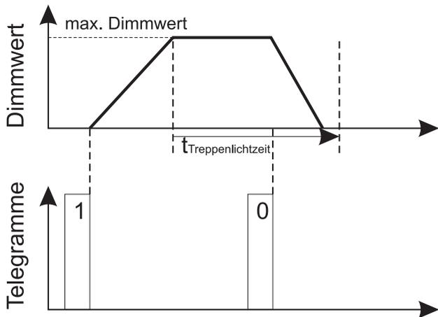
Ist eine Ausschaltverzögerung parametrierbar, so wird diese Funktion nun aktiv und der Ausgang schaltet erst nach Ablauf der Verzögerungszeit aus.
