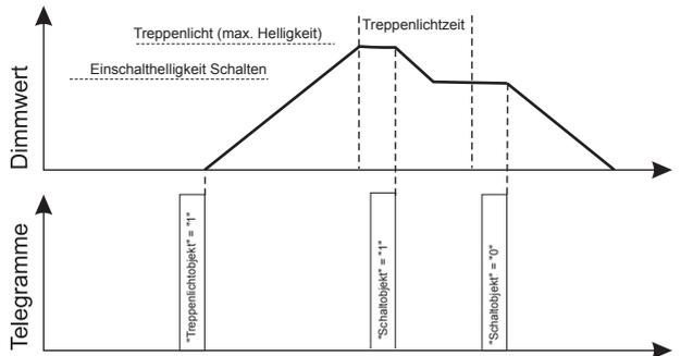
Dies können Sie z. B. für eine vorübergehende Dauerlichtschaltung (Reinigungsbeleuchtung) verwenden. Durch ein Eintelegamm vom Schaltobjekt bleibt das Licht bei Treppenlichtzeitfunktion ständig eingeschaltet. Wert-, Dimm-, Szenen- und Zentraltelegramme hätten aber weiterhin einen Einfluss. Sinnvoll wäre für eine solche Anwendung eine Einschalthelligkeit von 100%.
