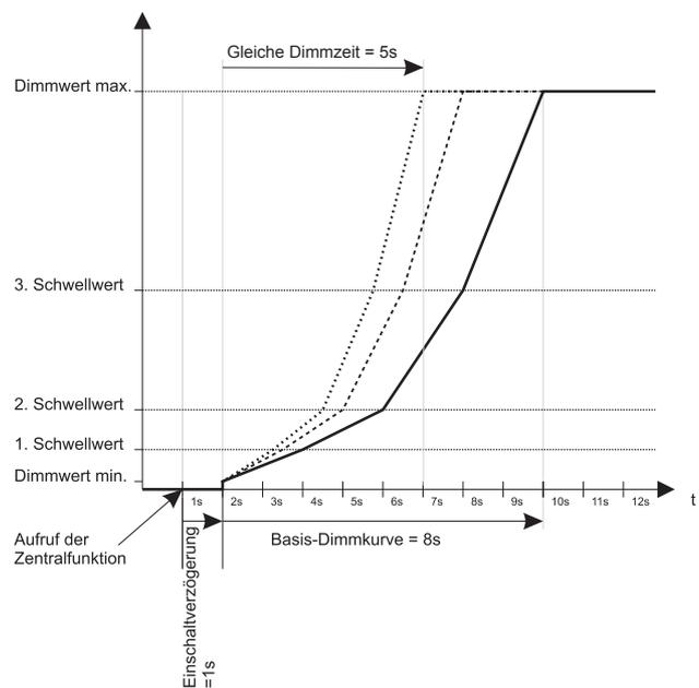
Die Einschaltverzögerung bleibt auch bei einer „gleichen Dimmzeit“ erhalten. Die Dimmkurve wird so gestaucht oder gestreckt, dass der Dimmwert nach der gleichen Dimmzeit erreicht wird. D. h., die Berechnung der neuen Dimmkurve berücksichtigt nur die reine Dimmzeit (gleiche Dimmzeit minus Einschaltverzögerungszeit).
