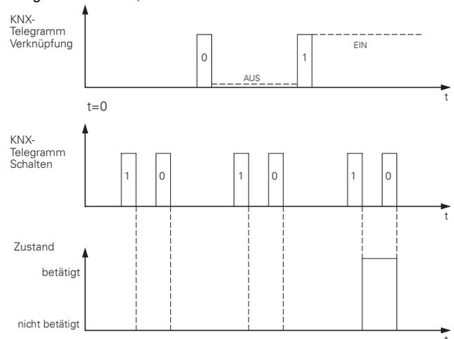
Die Parametereinstellung bewirkt ein Setzen des „Verknüpfungsobjektes“ auf den Wert „0“. Nach einem RESET wird der Aktor in der Betriebsart „Schließer“ und diesen Einstellungen den Ausgang solange nicht schalten, bis auf dem „Verknüpfungsobjekt“ ein „1-Telegramm“ empfangen wurde.
