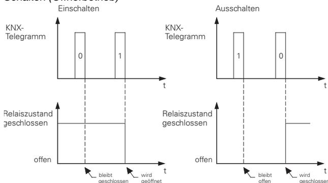
Nach Busspannungswiederkehr wird bei der Funktion „Öffner“ das Relais geschlossen und bei aktivierter Rückmeldefunktion ein „1“-Rückmeldetelegramm erzeugt. Es sei denn ein anderes Verhalten wird z.B. durch eine übergeordnete Funktion oder Verhalten bei Busspannungswiederkehr am Ausgang durchgesetzt.
