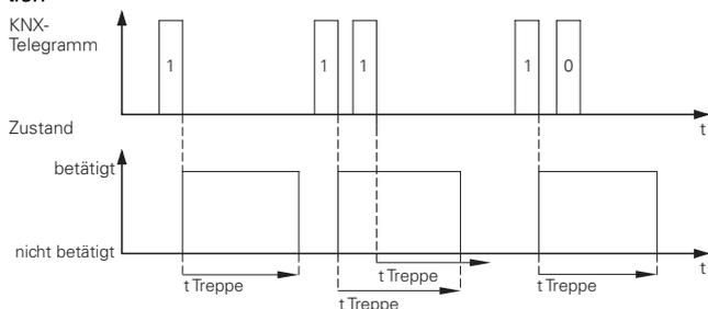
Über den Parameter „mit / ohne manuell-Aus-Funktion“ ist für die Treppenlichtzeitfunktion einstellbar, ob nach Empfang eines „0“-Telegramms vorzeitig ausgeschaltet oder ob das „0“-Telegramm ignoriert wird und die Treppenlichtzeit weiter abläuft.
