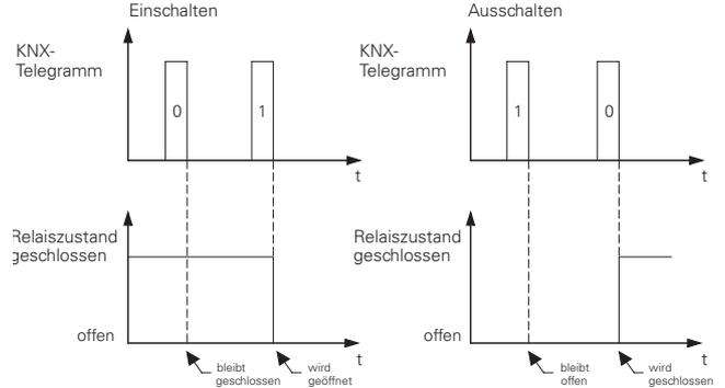
Die fest parametrierbaren Relaisstellungen (geöffnet, geschlossen) innerhalb der anderen Funktionen werden direkt angesteuert. Ein Invertieren durch die Öffner-Funktion erfolgt bei diesen fest parametrisierten Relaisstellungen nicht mehr.
