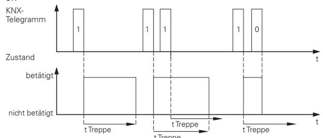
Die Treppenlichtzeitfunktion kann das bevorstehende Ende der Treppenlichtzeit durch Flackern der Leuchte anzeigen. Die Anzahl der Vorwarnungen ist dabei in einem Bereich von einer bis drei Vorwarnungen wählbar. Die Zeit ( $t_{\text{Vorwarn}}$ ), bei der die Vorwarnungen vor Ablauf der Treppenlichtzeit starten sollen, ist einstellbar. Die Länge der Unterbrechungen ( $t_u$ ) und der zeitliche Abstand zwischen zwei Unterbrechungen ( $t_{zv}$ ) sind ebenfalls einstellbar.
