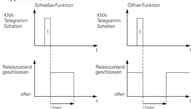
Man berechnet die Zeiten ( $t_{\text{Treppe}}$ ) aus einem Basiswert multipliziert mit einem Faktor.
