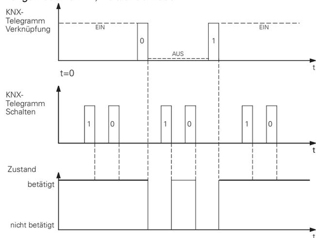
Das Verknüpfungsobjekt wird nach einem RESET mit dem Wert „1“ vorbelegt. Der Aktor wird in der Betriebsart „Schließer“ den Ausgang sofort einschalten. Die ODER-Verknüpfungsfunktion wird erst durch ein „0-Telegramm“ auf dem Verknüpfungsobjekt zurückgesetzt.
