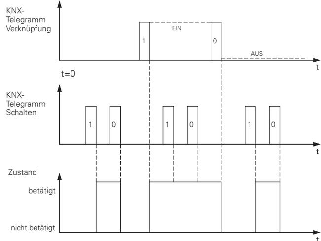
Nur wenn über das „Verknüpfungsobjekt“ ein „0“-Telegramm empfangen wurde, kann das Relais über das „Schaltobjekt“ ausgeschaltet werden.
