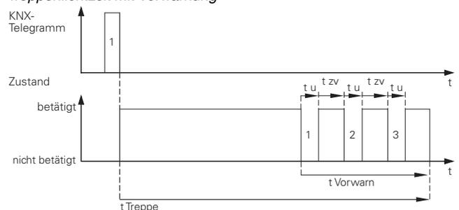
Bei Treppenlichtzeitfunktionen mit Manuell-Aus-Funktion und eingeschalteter Vorwarnung wird die Vorwarnung bei Empfang eines Aus-Telegramms sofort deaktiviert.
