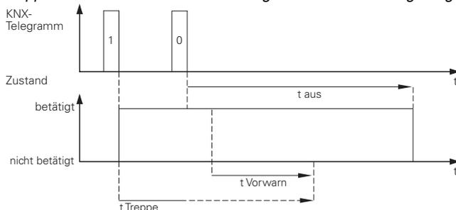
Bei Treppenlichtzeitfunktionen mit Manuell-Aus-Funktion und eingeschalteter Vorwarnung wird die Treppenlichtzeitfunktion mit Vorwarnung bei Empfang eines Aus-Telegramms sofort deaktiviert. Die Ausschaltverzögerung läuft ab. Es kommt zu keiner Vorwarnung.
