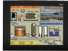
LCD STN couleur ou LCD TFT couleur, rétro-éclairé (640 x 480 pixels) ou (800 x 600 pixels) (4)      LCD TFT couleur, rétro-éclairé (800 x 600 pixels)      LCD TFT couleur, rétro-éclairé (1024 x 768 pixels)
