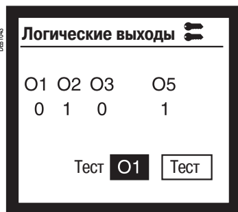
Пример экрана, представляющего логические выходы базового устройства, с указанием состояния каждого выхода и возможным тестированием каждого выхода
