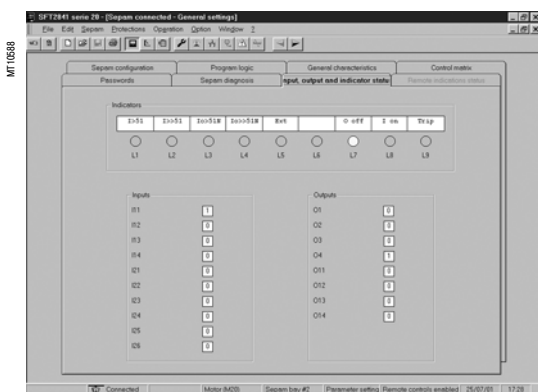
Экран "Состояние входов, выходов, сигнальных ламп"
