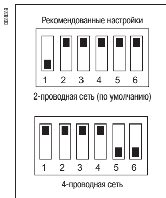
Настройка сети RS485
