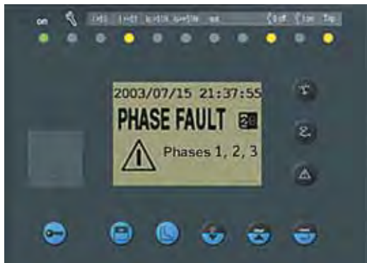
Сигнализация на передней панели Sepam при местном управлении
