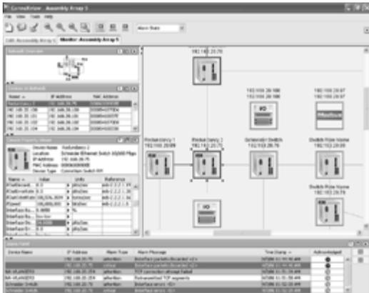
Автоматическое распознавание IP-устройств при помощи диагностического ПО SolarisView для промышленных сетей Ethernet
