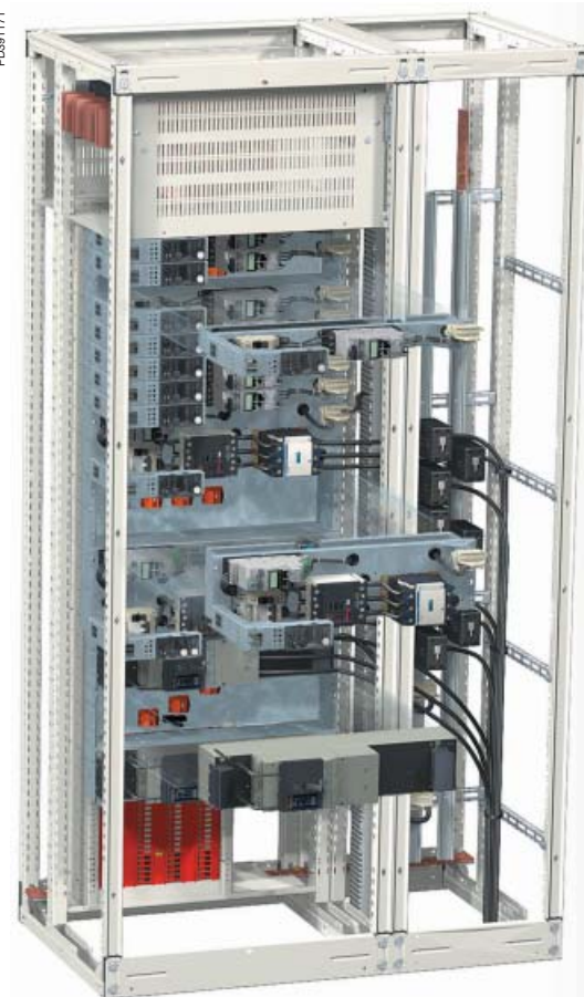
A kihúzható szerelőlapok 650mm széles és 600mm mély kapcsolószekrényekbe szerelhetők be, ezért a Prisma Plus kapcsolószekrényekkel a kompatibilitás feltételei teljesülnek. A függőleges befogadóképesség 30 modul (1 modul = 50 mm).
