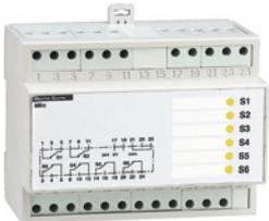
Contacts M6C : relais externe au disjoncteur à 6 contacts inverseurs indépendants pilotés depuis le disjoncteur par une connectique 3 fils. (L.max : 10 mètres).
