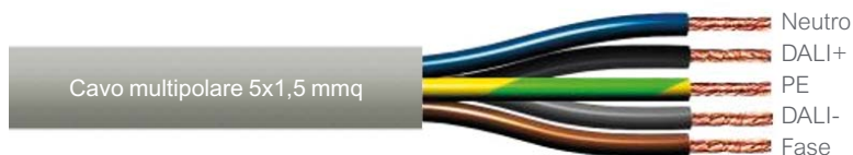
Fig. 37. Distribuzione di potenza e bus DALI in un unico cavo multipolare
