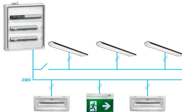
Per loro natura, gli apparecchi autoalimentati garantiscono la continuità di servizio, continuando a funzionare anche in caso di interruzione fisica della linea di alimentazione (dovuta ad esempio a cedimenti strutturali), oltre al fatto che, se la batteria di un apparecchio si guasta, tutti gli altri rimangono operativi, non inficiando di molto le condizioni globali di sicurezza del sistema.
