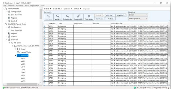
In caso di sostituzione di una lampada guasta con una nuova, è possibile associare alla nuova lampada la stessa numerazione della precedente tramite il comando «Sostituisci» senza dover rifare l'indirizzamento di tutti gli apparecchi
