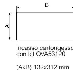
\* È possibile installare Exiway Trend ad incasso utilizzando la stessa scatola ad incasso dei modelli precedenti Exiway Easyled escluso il modello OVA38365
