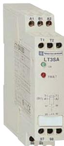
↑ Fig. 62 Dispositivo elettronico (LT3 - Telemecanique) da associare a tre sonde a termistori, per comandare l'arresto di un motore per superamento di temperatura
