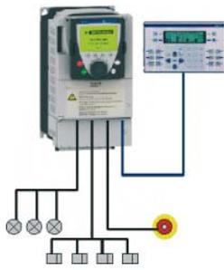
↑ Fig. 8 Sezione di nastro trasportatore comandato da un ATV71 con scheda controllore integrata
