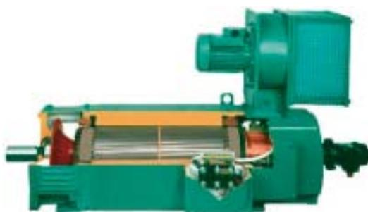
↑ Fig. 17 Motore a corrente continua
