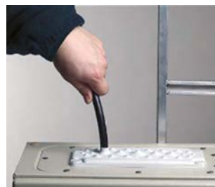
Tirare indietro il cavo o il tubo di circa 20 mm per bloccarlo.
