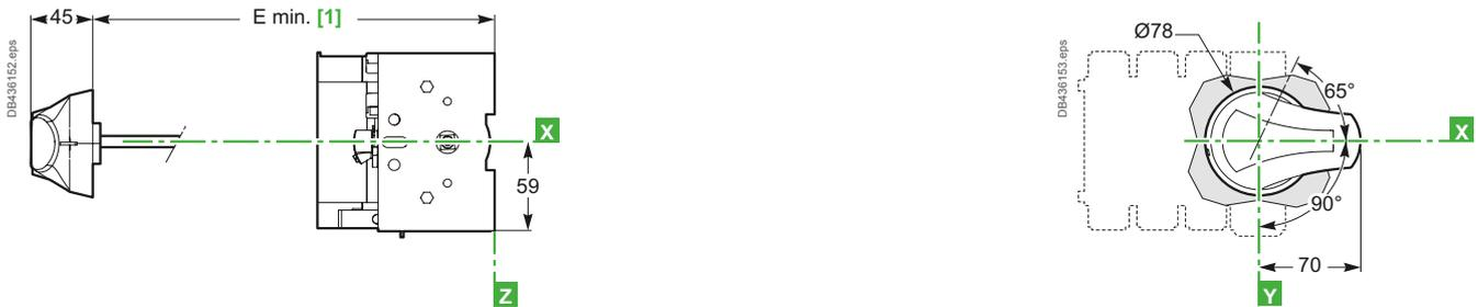
[1] FuPacT GS 50 A : 1 contatto ausiliario GS1 AM1●●: E + 23.5 mm, 2 contatti ausiliari GS1 AM1●●: E + 47 mm.
