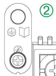
Pas de mise à la terre
