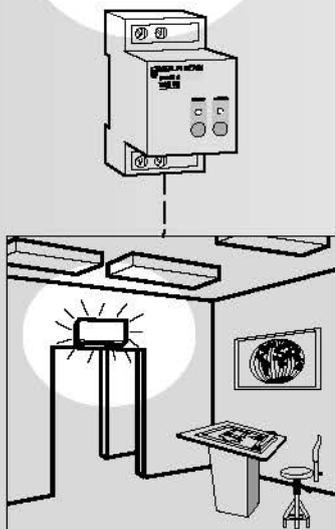
**Le secteur est absent** : allumage automatique des blocs d'éclairage de sécurité (par ex. : fermeture des locaux).
