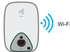
Mettez le chargeur EVlink Home Smart sous tension pour activer le point d'accès Wi-Fi. Le point d'accès Wi-Fi restera actif pendant 4 minutes après la mise sous tension.
